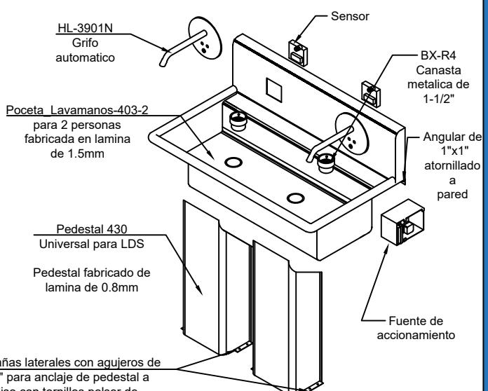
Pestañas laterales con agujeros de 1/4" para anclaje de pedestal a piso con tornillos polser de 1/4"x1-1/2" y tarugo azul de 3/8"x1-1/2".
